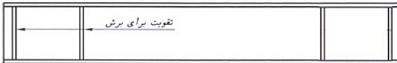
شکل ۲-۴-۲۳- اضافه نمودن ورق های سخت کننده عرضی
