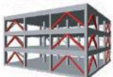
شکل ۴-۱- افزایش مقاومت و سختی سازه بوسیله اضافه نمودن قاب خمشی، مهاربند و دیوار برشی
