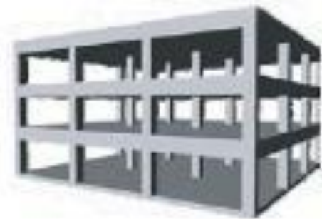
شکل ۴-۱- افزایش مقاومت و سختی سازه بوسیله اضافه نمودن قاب خمشی، مهاربند و دیوار برشی
