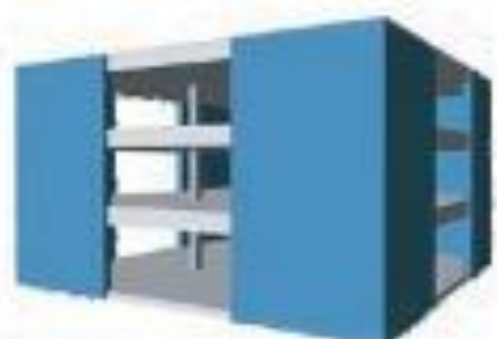
شکل ۴-۱- افزایش مقاومت و سختی سازه بوسیله اضافه نمودن قاب خمشی، مهاربند و دیوار برشی
