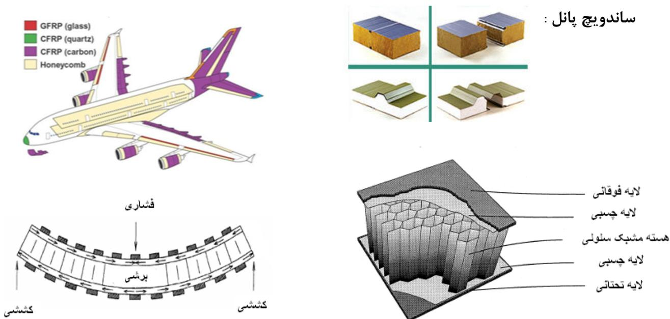
یک ساختار سبک و مرکب است که از دو طرف به دولایه محدود شده و در وسط آن یک لایه عایق قرار دارد ، ماده این عایق می بایست بسیار نرم و سبک و دارای خواص فیزیکی خاص باشد .ساندویچ پانل های بارون به دو گروه پانل های سقفی و پانل های دیواری تقسیم می شوند:
